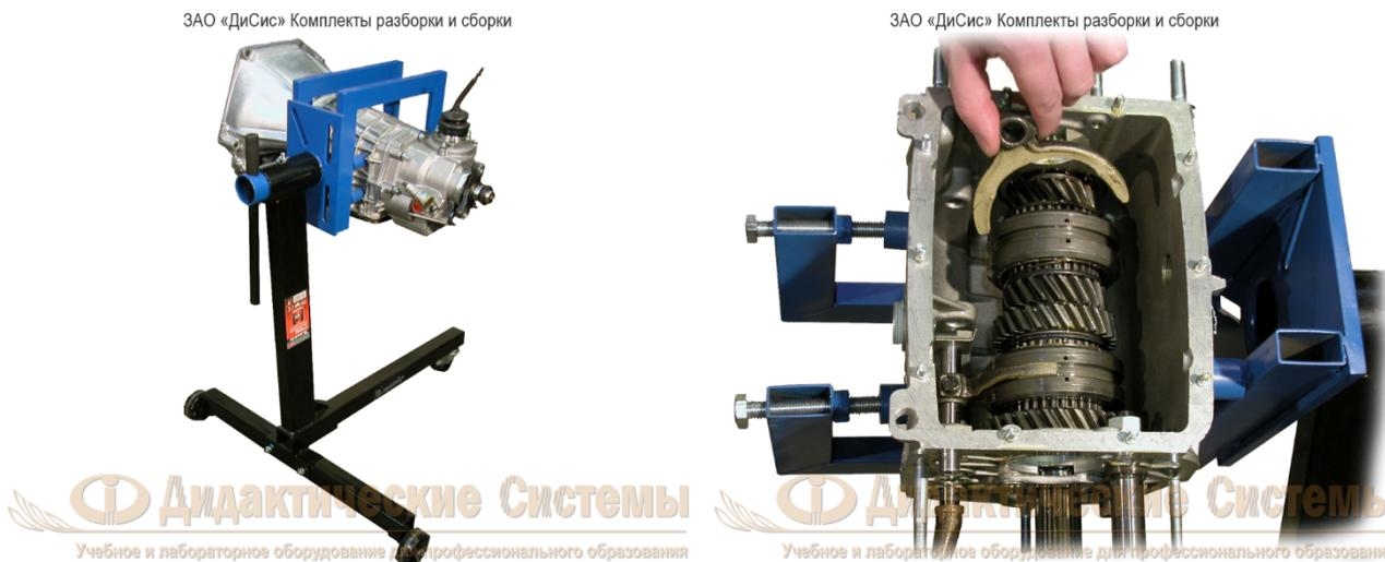
**Наименование:** Стенд «Комплект разборки и сборки МКПП заднеприводного автомобиля»
